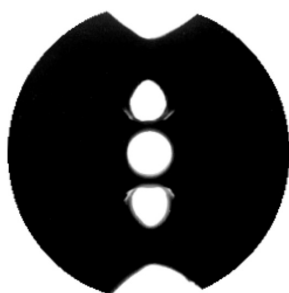
Рис. 4. Фотография полого цилиндрического образца, окруженного магнитной жидкостью суммарным объемом 159 см 3
