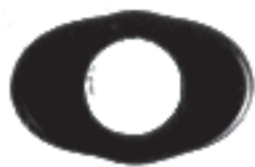
Рис. 2. Фотография полого цилиндрического образца, окруженного магнитной жидкостью суммарным объемом 2,6 см 3
