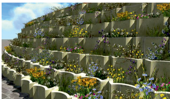
Рис. 2. 3D-модель цветника на основе железобетонных модулей с высаженными в них дикорастущими растениями из луговых сообществ
