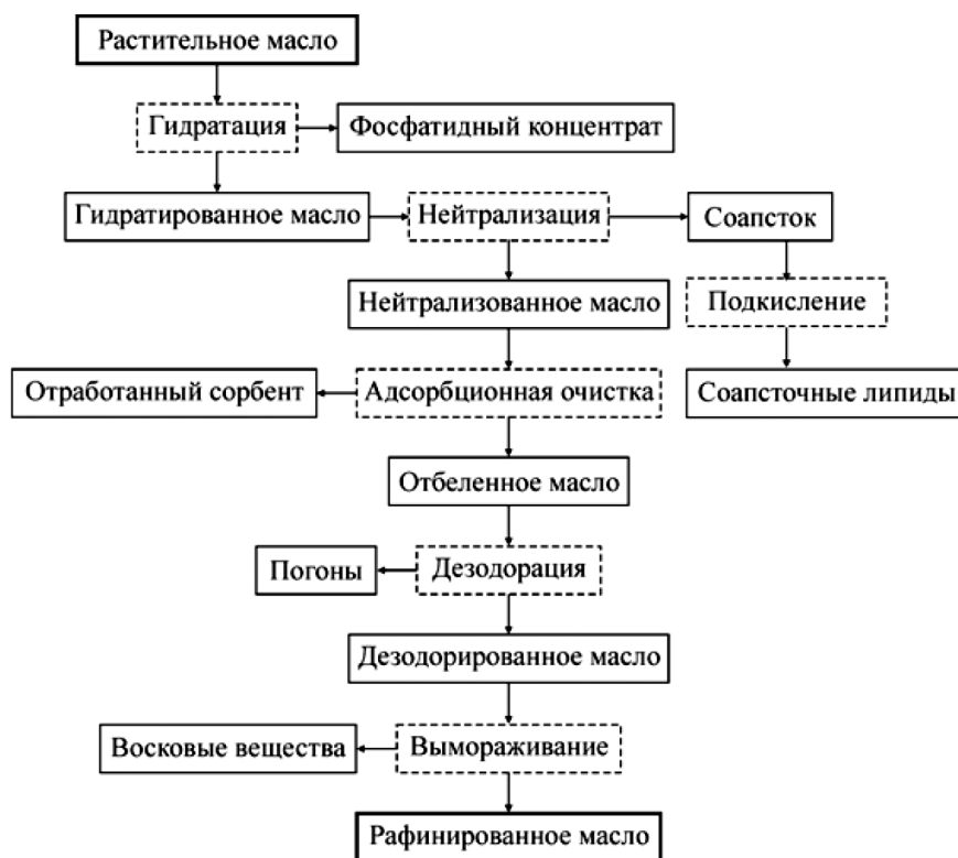
Рис. 3. Блок-схема рафинации растительного масла [5]
