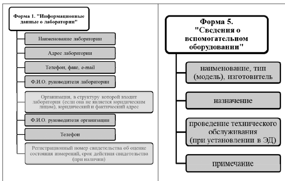
Рис. 2. Содержание информационных данных и сведений о вспомогательном оборудовании лаборатории, регламентированных МИ 2427–2016 (новые формы паспорта МО)
