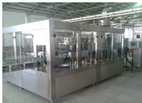
Внешний вид триблока по розливу газированной воды
