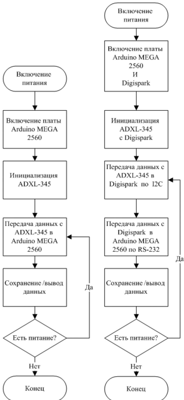
Рис. 3. Алгоритмы работы измерительной системы. Слева – при непосредственной передаче, справа – с устройством-посредником
