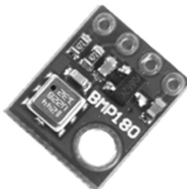
Рис. 2. Датчик давления BMP180
