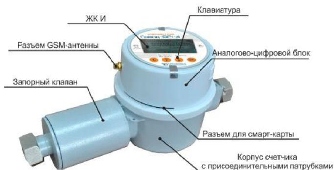
Рис. 2. Газовый счетчик и электромагнитным клапаном (а) и ТМСВ (б)
