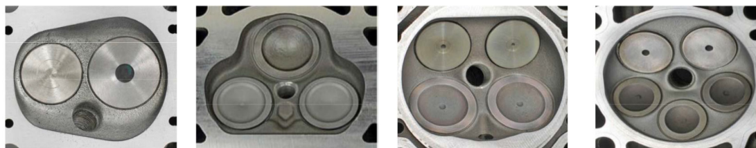
Рис. 2. Схема расположения клапанов в цилиндре
