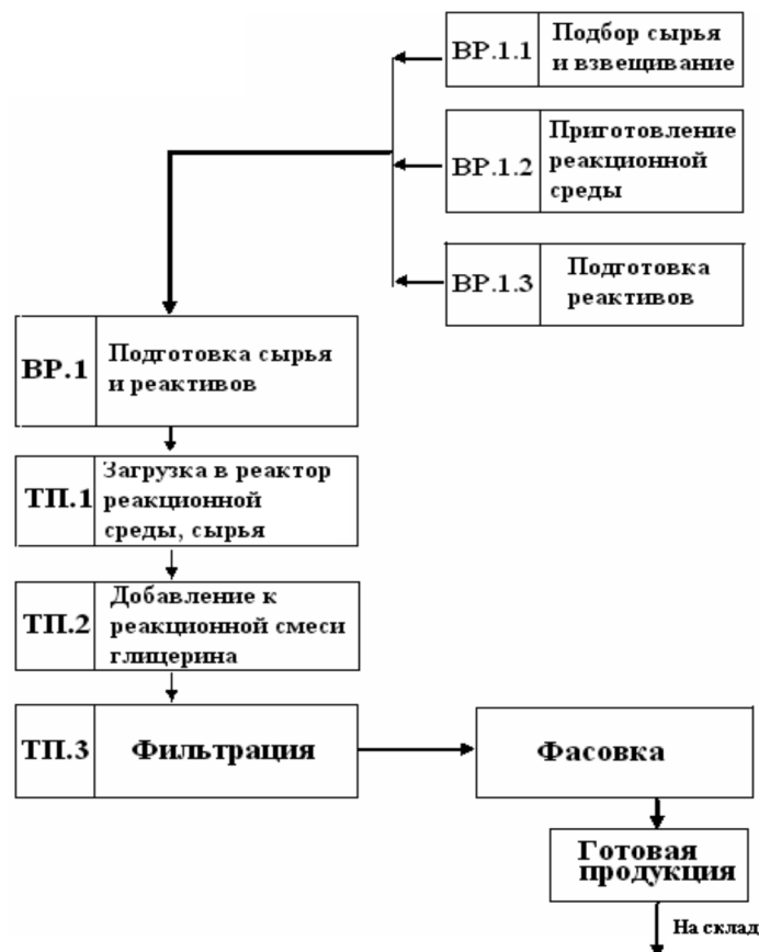
Рис. 4. Технологическая схема производства поликомплексных гелей на основе Na-КМЦ и МФО BR.1.1, BR.1.2, BR.1.3 – вспомогательные работы; ТП.1, ТП.2, ТП.3 – технологические процессы
